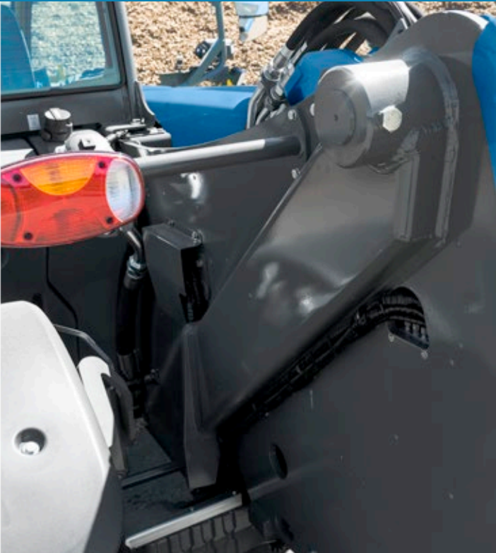
Rammeforsterkning ved hovedlageret
