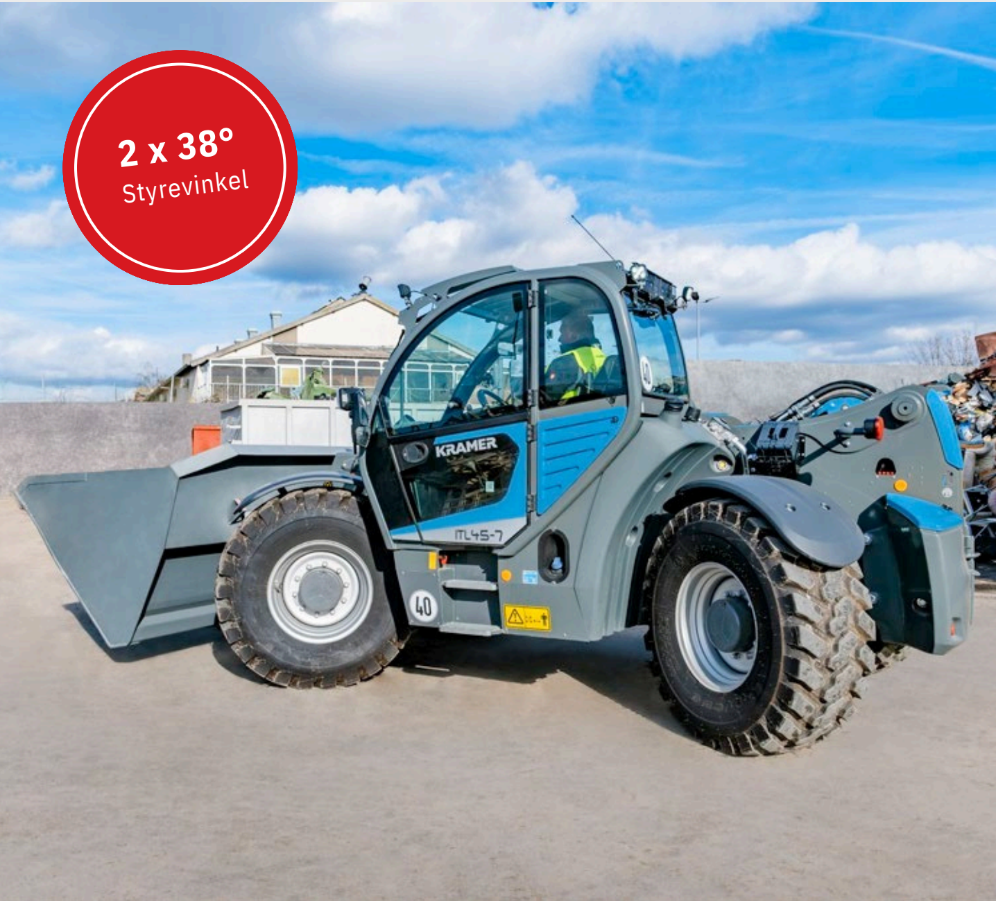
Firehjulsstyring: spesielt manøvrerbar på trange områder
