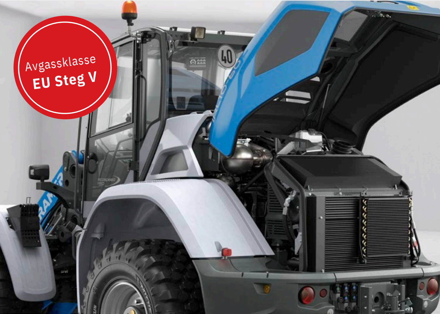
Vannkjølt 4-sylindret rekkemotor med kjølt ekstern eksosresirkulering, turbo og ladeluftkjøler.
